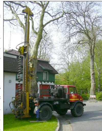
Untersucht und dargestellt werden können die Bodenschichten selbst und / oder die Standfestigkeit (Diagr.) ohne Bauteilöffnung durch vorhandene Bauwerke hindurch.
